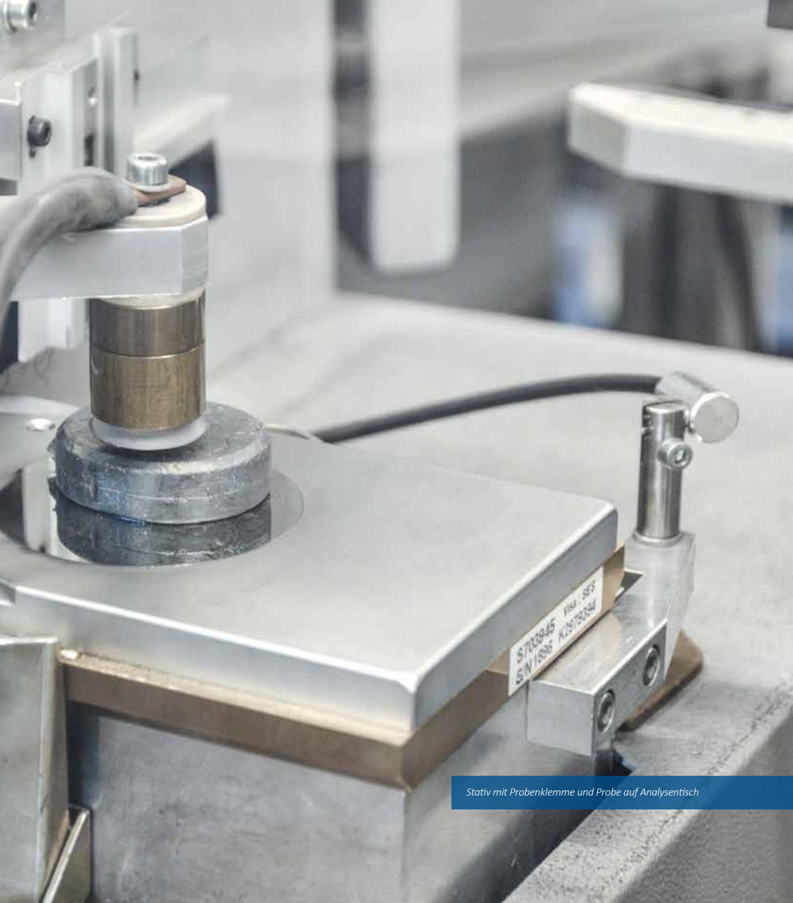
Stativ mit Probenklemme und Probe auf Analysentisch
