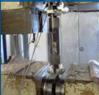
Versuchsaufbau für seismischen Schlupf- und Traglastversuch im Labor 2 von SAH
